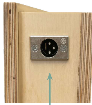
Aansluiting voor 12V voeding
