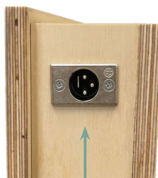
Connexion pour l'alimentation 12V
